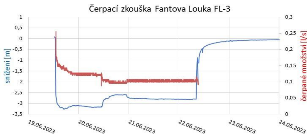
Obr. 20: Průběh hydrodynamické zkoušky na vrtu FL-3.
