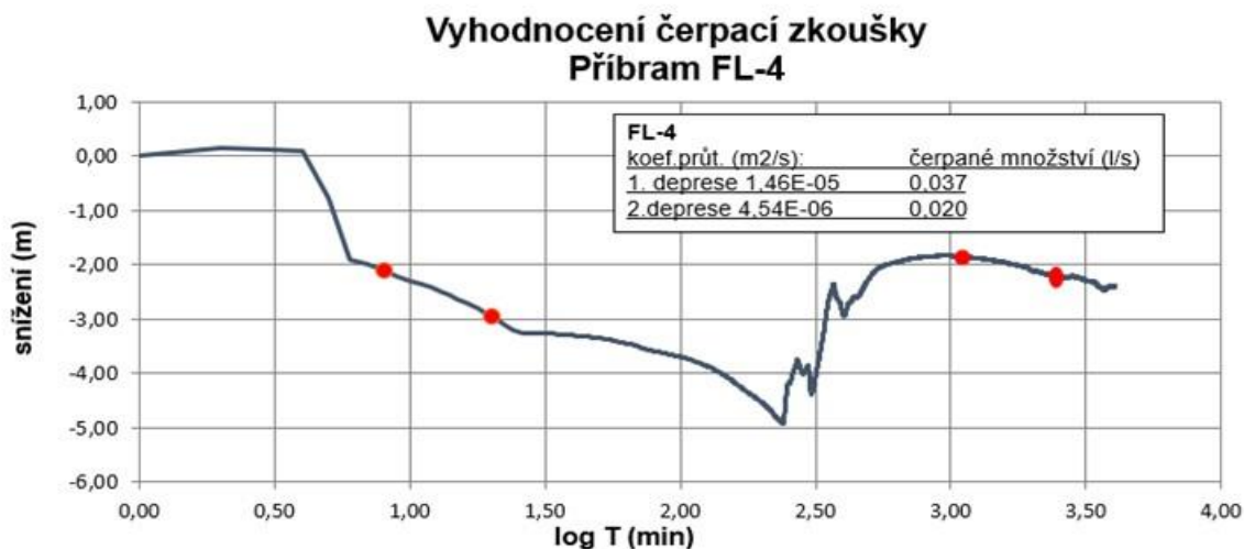
Obr. 24: Vyhodnocení čerpací zkoušky na vrtu FL-4.
