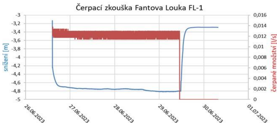
Obr. 14: Průběh hydrodynamické zkoušky na vrtu FL-1.
