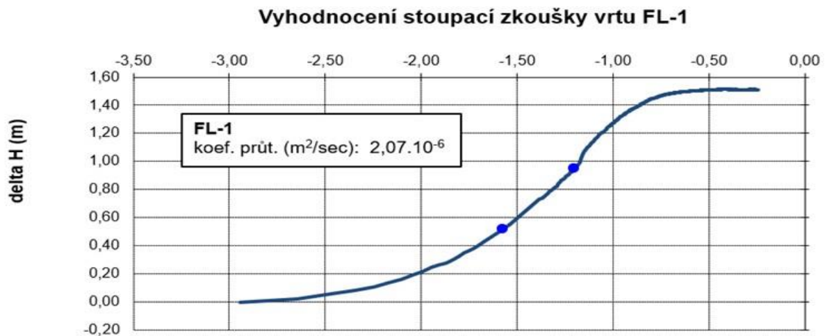
Obr. 16: Vyhodnocení stoupací zkoušky na vrtu FL-1.
