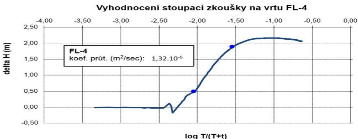
Obr. 25: Vyhodnocení stoupací zkoušky na vrtu FL-4.
